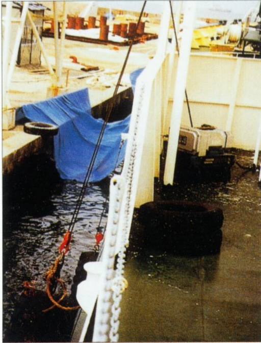
接岸時の緩衝用材を昇降する TX
