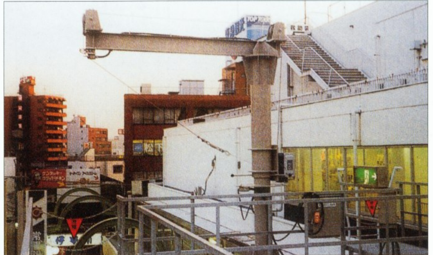
消防機材引き上げ用ジブクレーンに取付けられた TX
